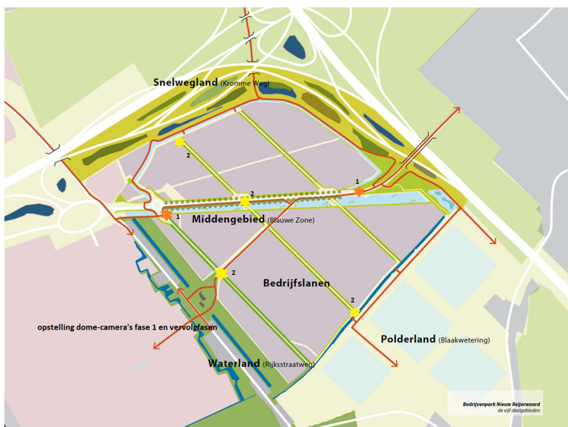
Afbeelding 6: opstelpunten en fasering camera's
